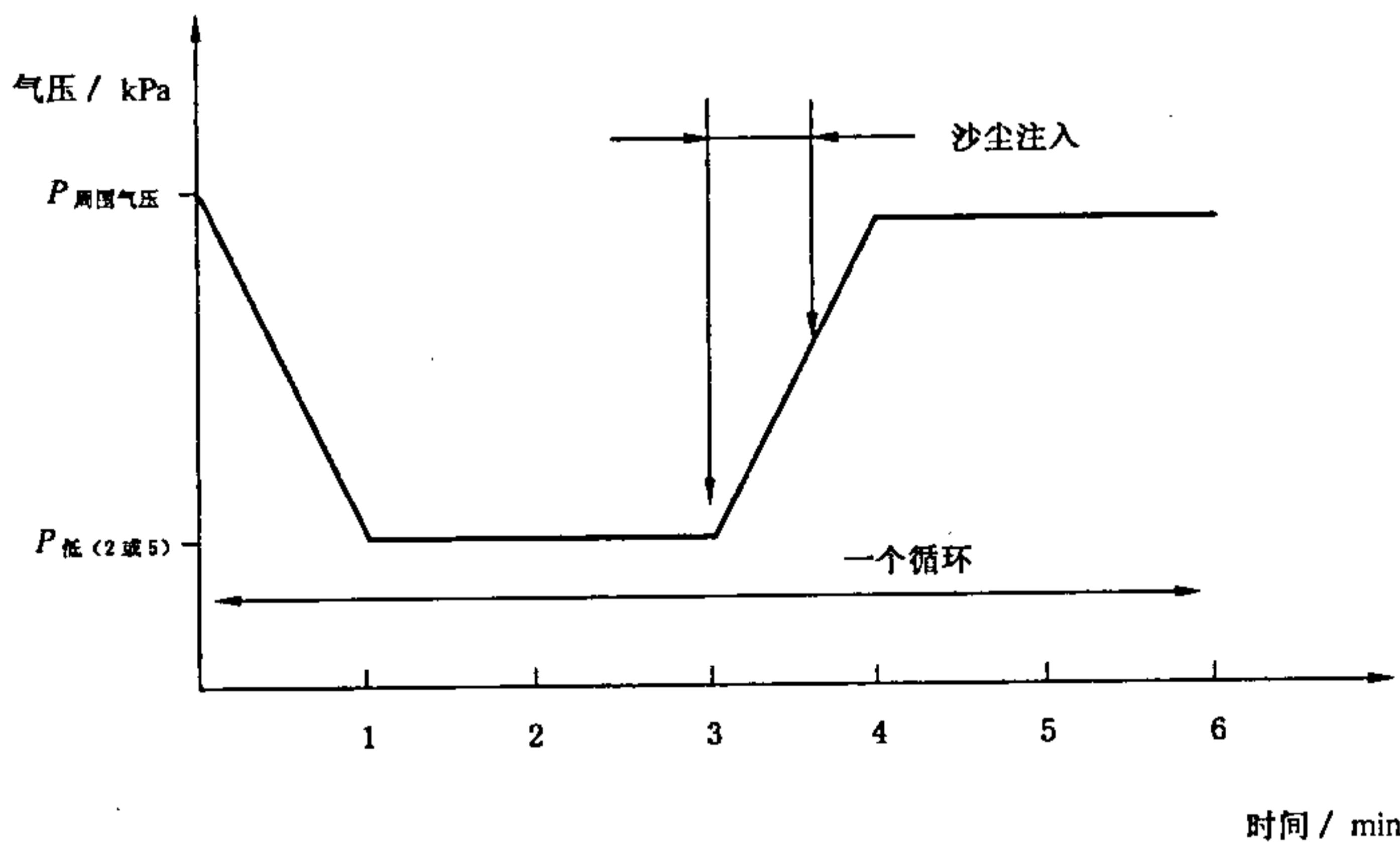
图 2 试验箱内的气压循环——类型 1
