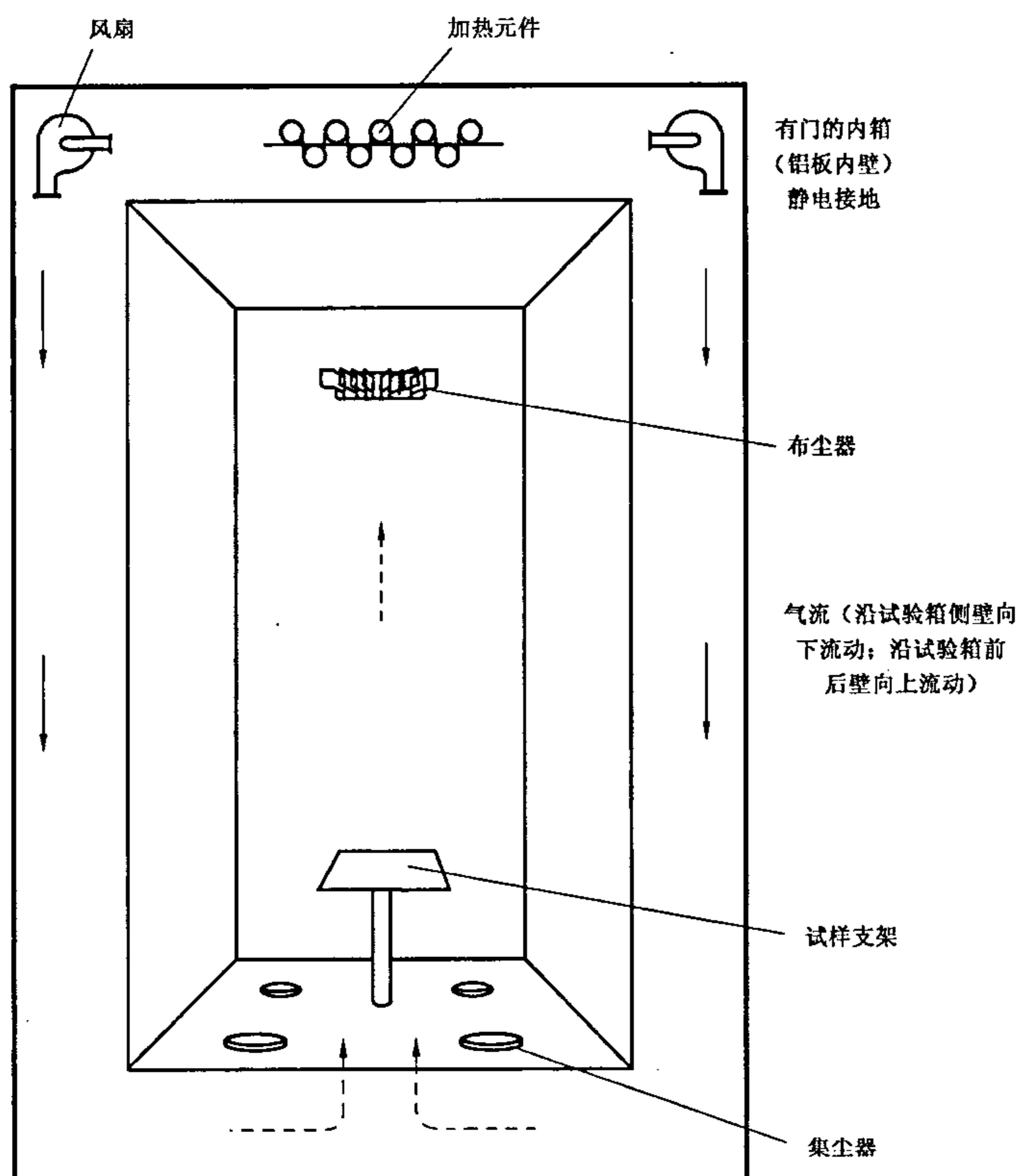
图 5 试验 Lb 适用的试验箱实例
