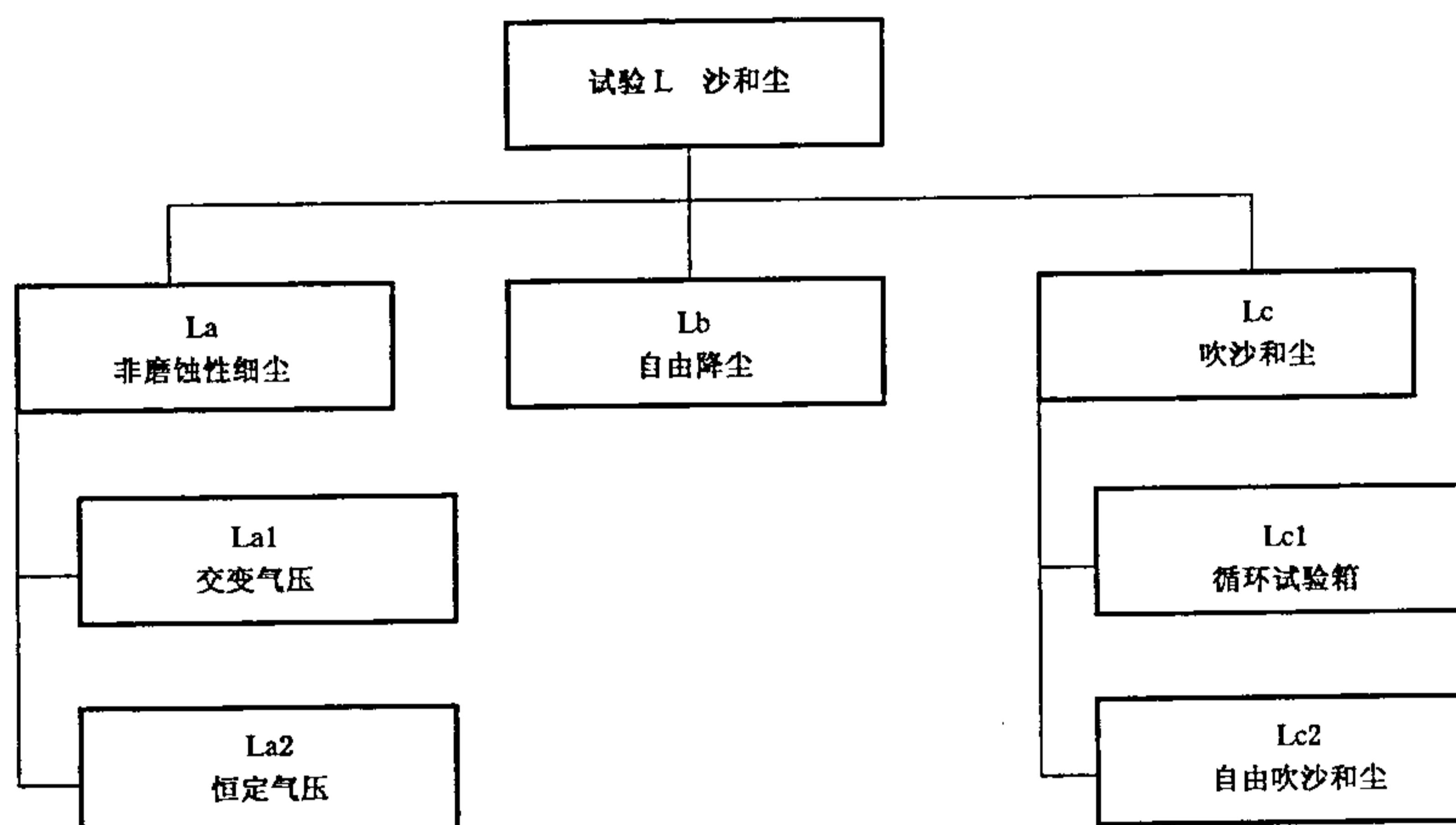
图 1 试验方法结构
