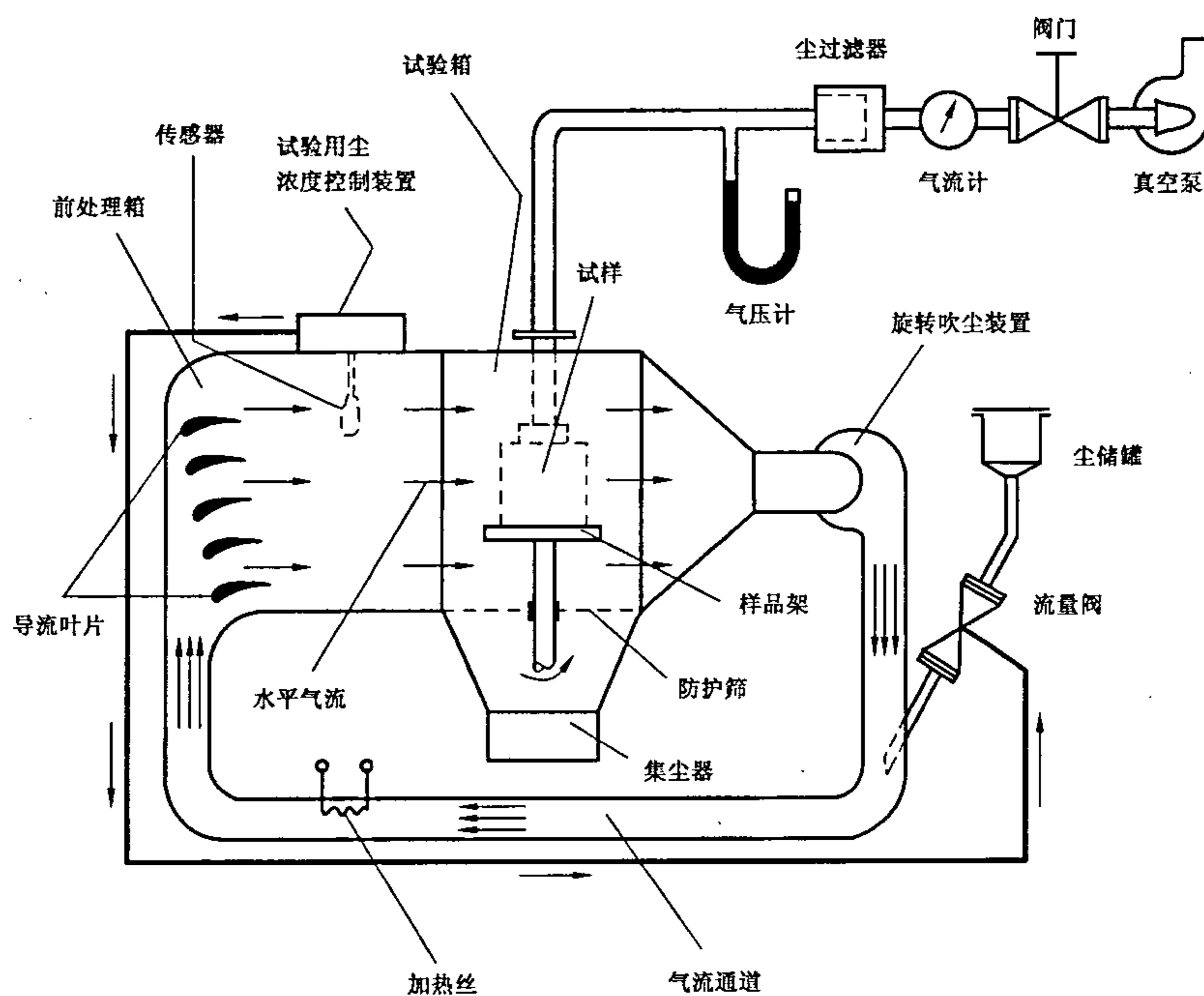
图 6 方法 Lc1 适用设备的基本布置图
