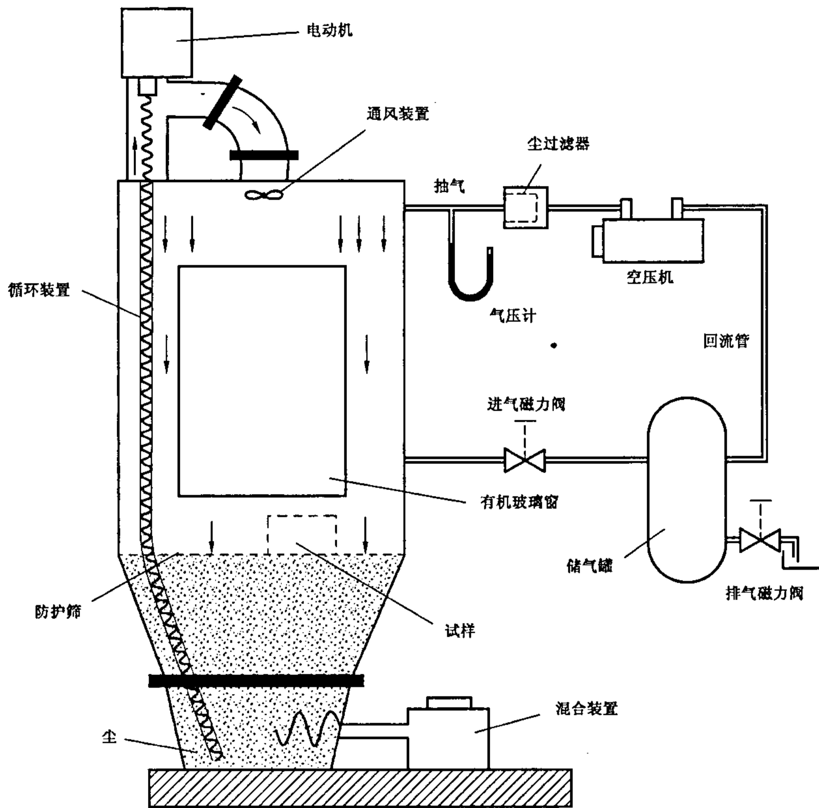
图 3 方法 La1 适用的试验箱实例
