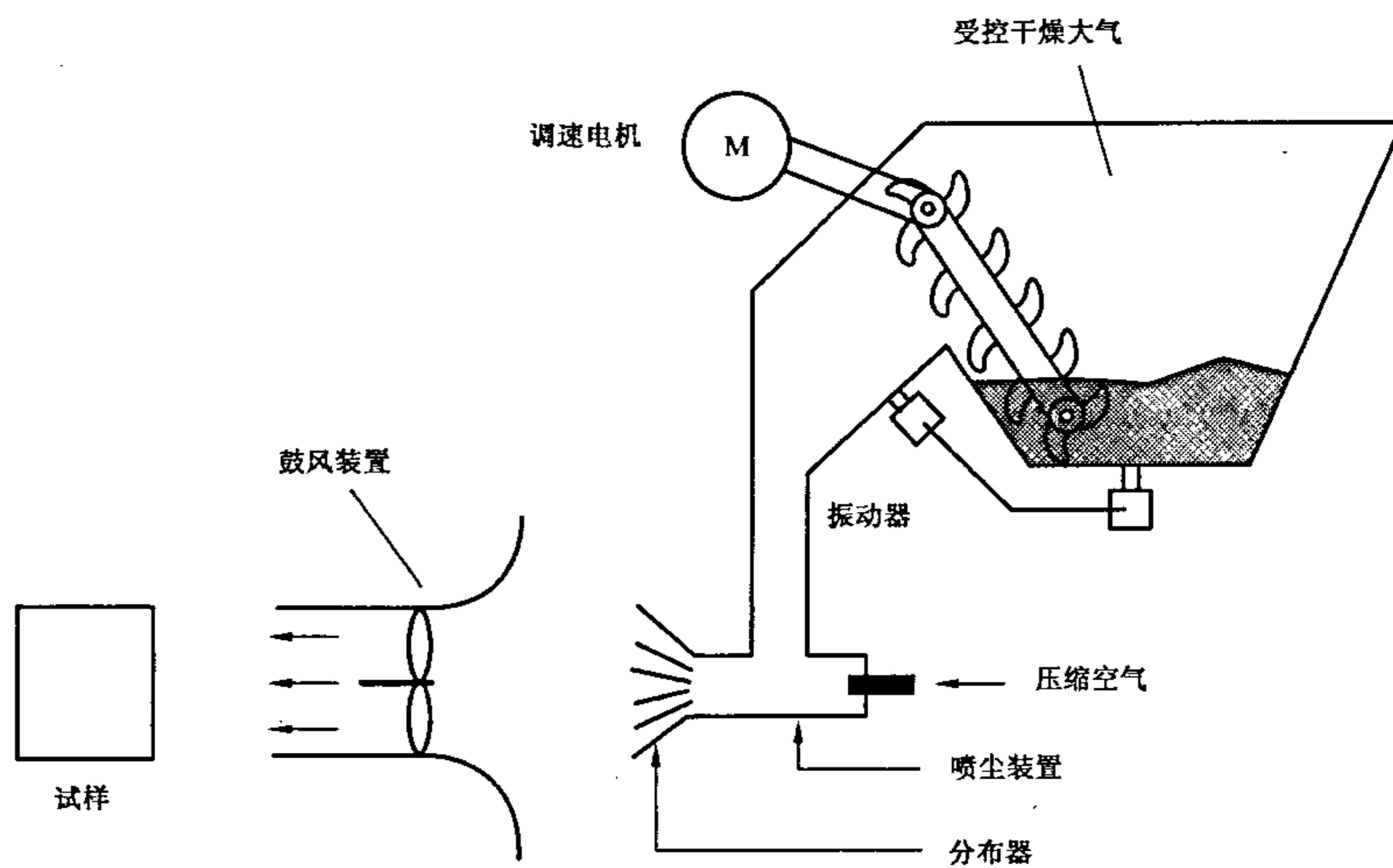
图 7 方法 Lc2 适用的喷尘系统实例
