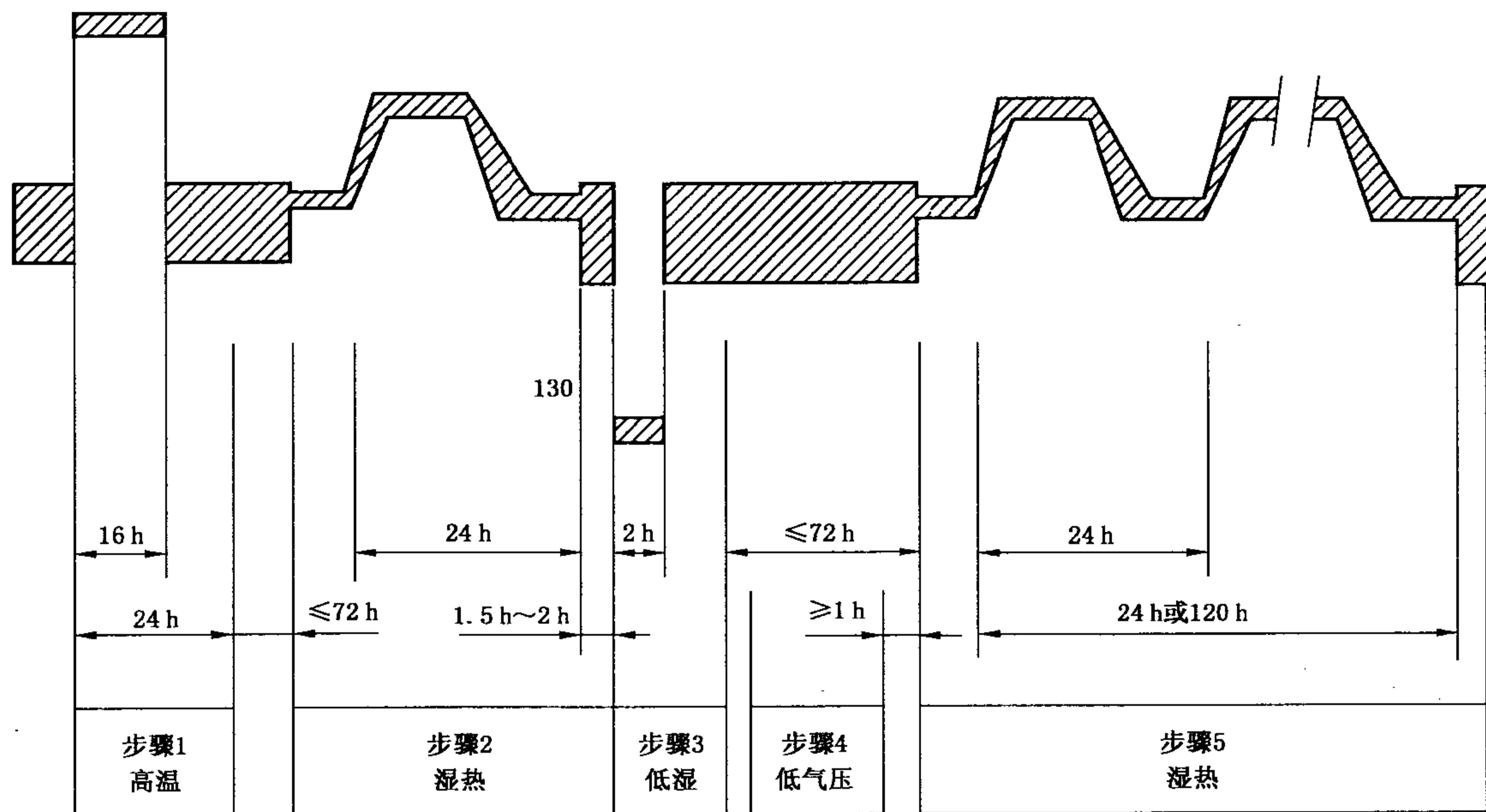
图 4 气候顺序试验进度示意图
