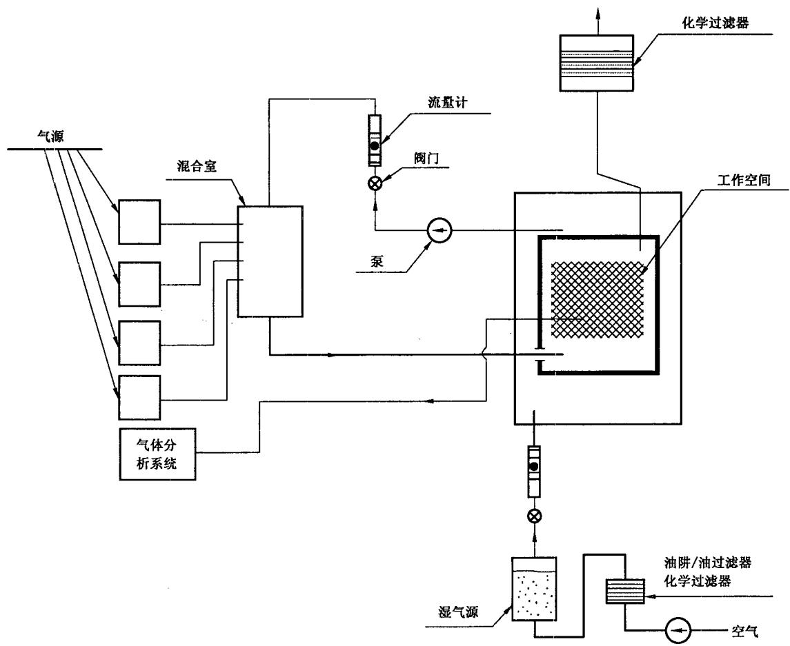
试验箱内的外层腔室(夹套)有湿空气
