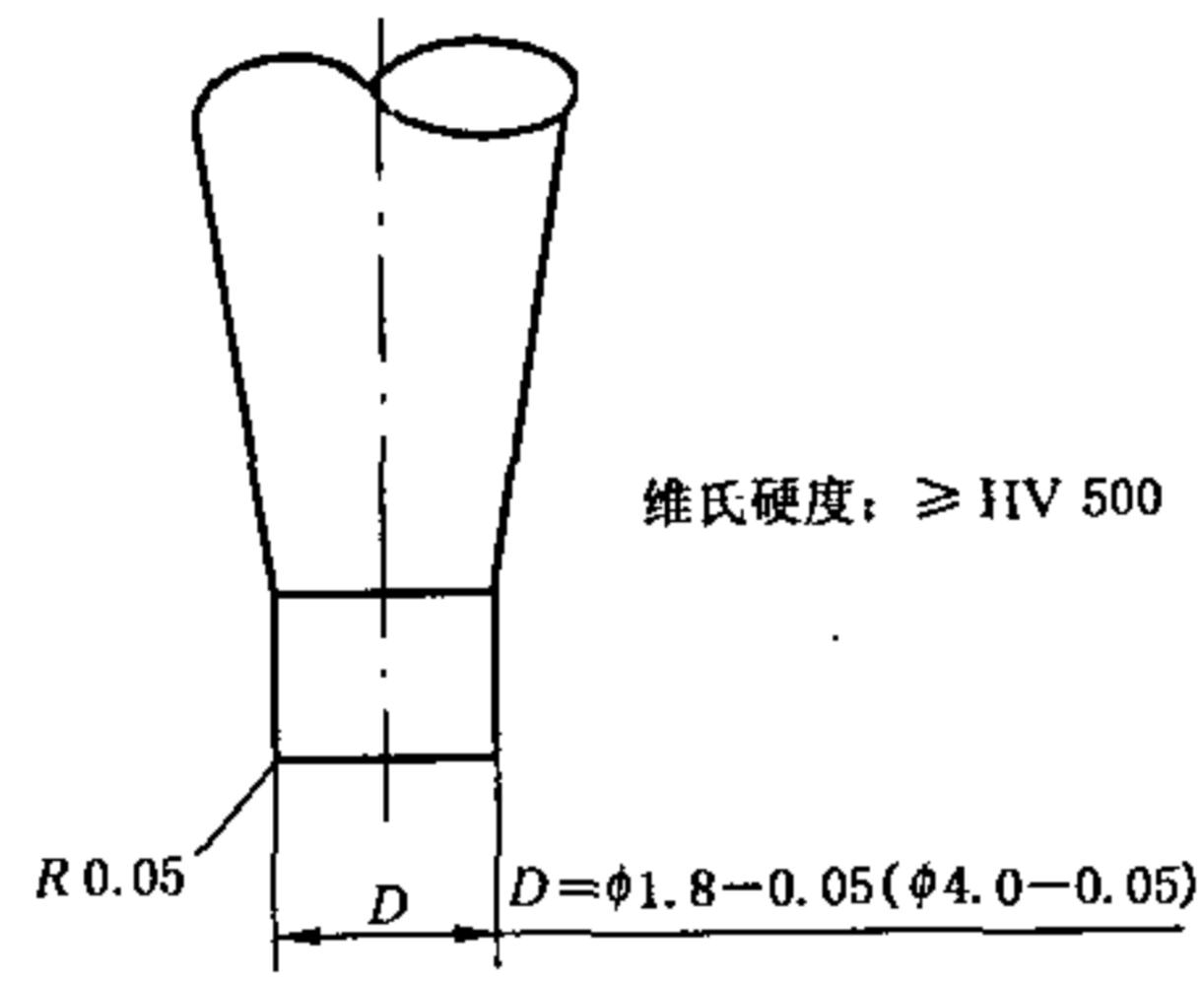
图 7 夹套图例
