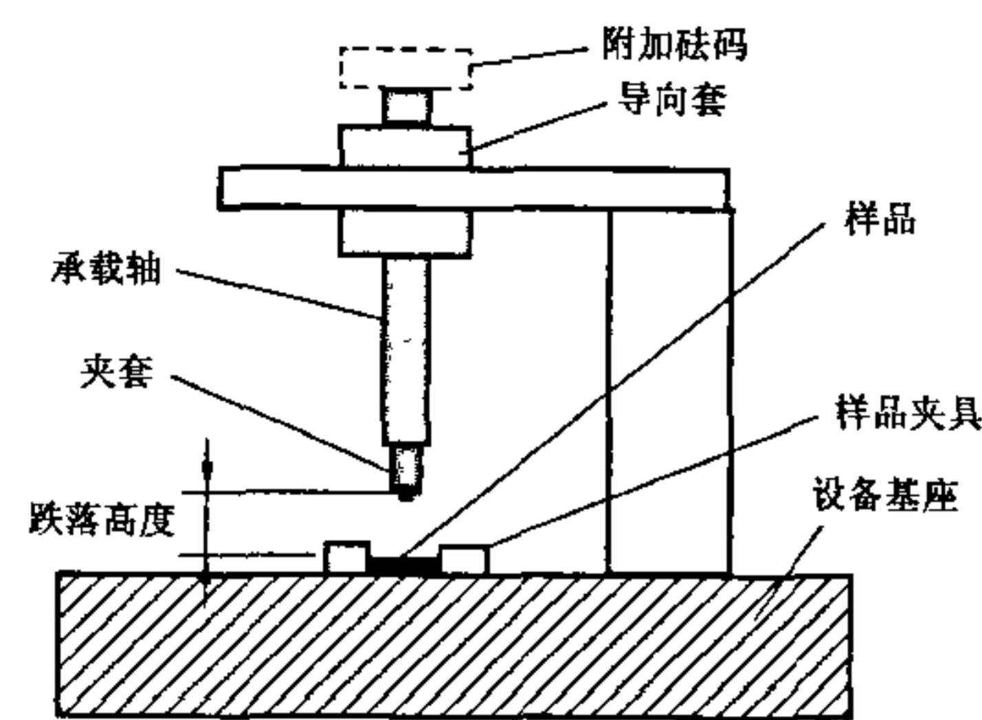
图 4 试验设备原理图
