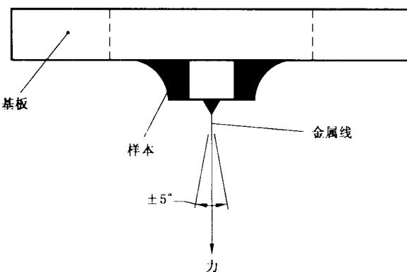
图 9 试验 Ue2:推脱试验
